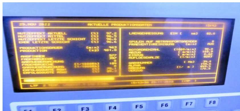
Рисунок 4 – Информатор пневмопрядильной машины Avtokoro 288 SE 11 фирмы Schlafhorst функционирующие на ОАО «Ресандаи Кулоб», Таджикистан
