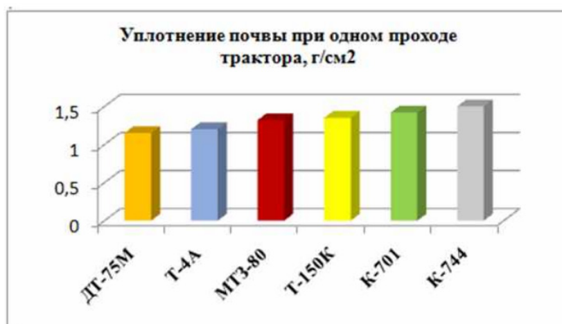
Рис. 3 - Уплотнение почвы движителями тракторов, при одном проходе
