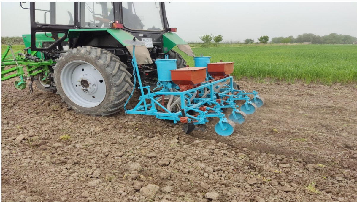
Рис. 1 – Общий вид посевного агрегата МТЗ-80Х+ УКС-2,4 «НЦИТМ» (вид сбоку) при выполнении технологического процесса
